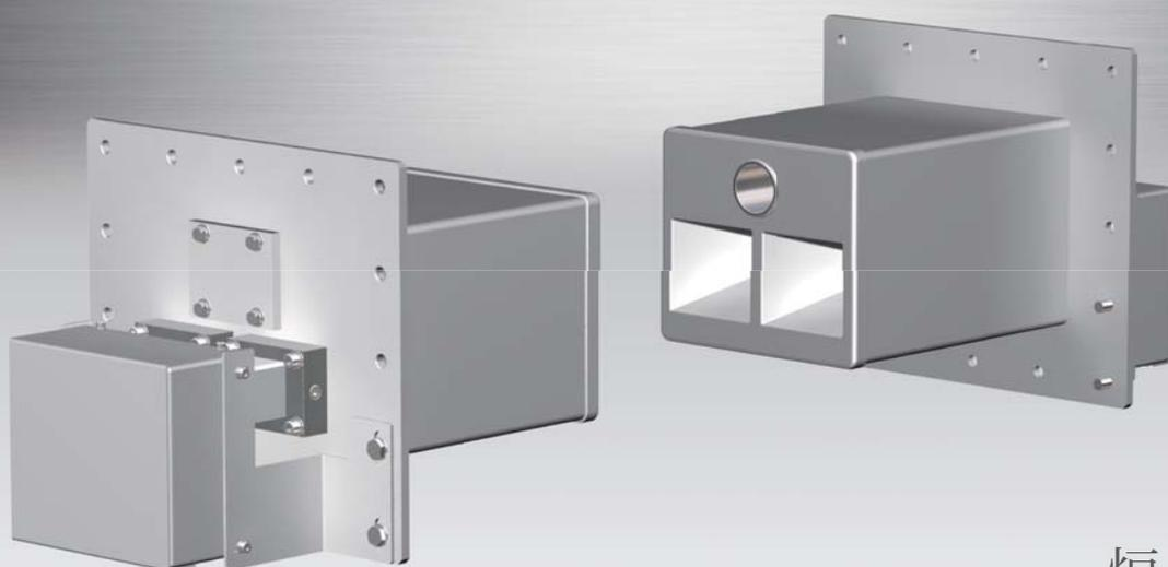
電磁波式 CPC センサは、炉壁内部に埋設されたアンテナから電磁波を放射し、ストリップエッジから反射され戻ってくる電磁波の伝搬時間よりストリップ位置を計測する従来にない新しい方式のセンサです。
