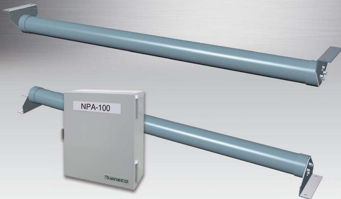
NS-CPCセンサは、電磁誘導方式によるストリップ（鋼板・金属板）のエッジ位置を連続的に検出して、ストリップのセンタ位置ずれを偏差信号として出力するセンサです。
